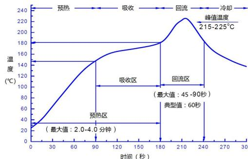
此图为推荐回流温度曲线，因基板及回流焊设备性能不同而有所差异。请依据使用的基板与回流设备确认实际温度曲线，实测回流基板温度不得超过极限参数中的装配温度。
