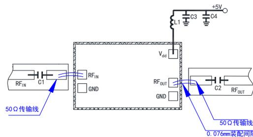
注: 射频端口应尽量靠近微带线以缩短键合金丝尺寸, 典型的装配间隙是 0.076~0.152mm, 使用  $\Phi 25\mu\text{m}$  双金丝键合, 建议金丝长度 250~400 $\mu\text{m}$ 。
