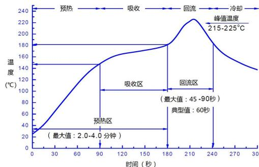
此图为推荐回流温度曲线，因基板及回流焊设备性能不同而有所差异。请依据使用的基板与回流设备确认实际温度曲线，实测回流基板温度不得超过极限参数中装配温度。
