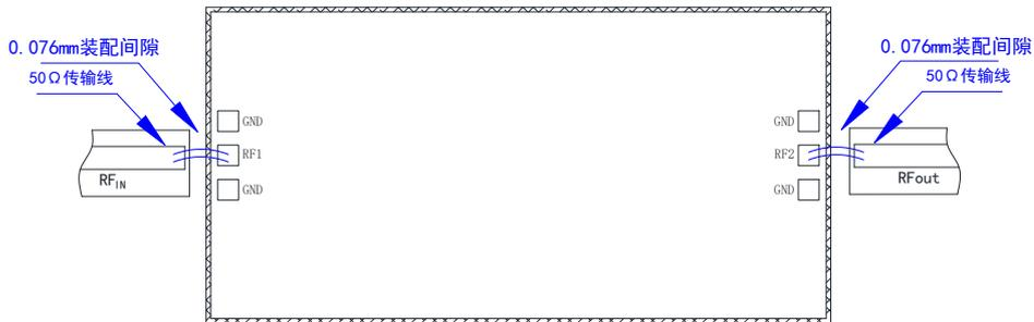
注：射频端口应尽量靠近微带线以缩短键合金丝尺寸，典型的装配间隙是 0.076~0.152mm，使用  $\Phi 25\mu\text{m}$  双金丝键合，建议金丝长度 250~400 $\mu\text{m}$ 。
