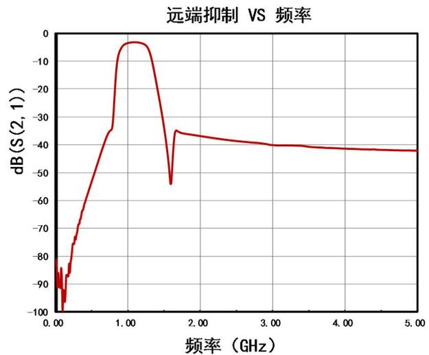
带外抑制 & 回波损耗 VS 频率
