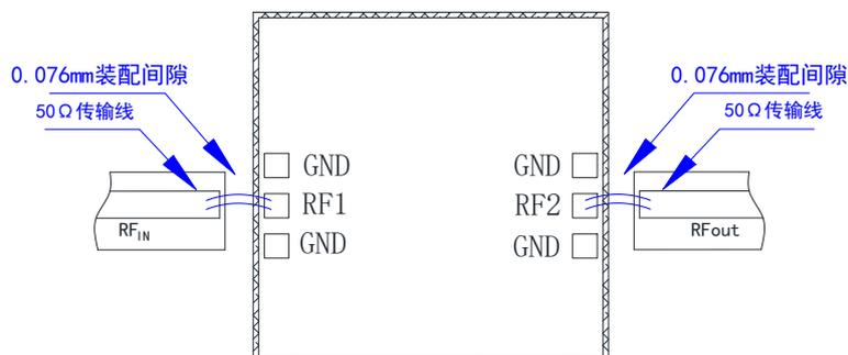
注: 射频端口应尽量靠近微带线以缩短键合金丝尺寸, 典型的装配间隙是 0.076~0.152mm, 使用  $\Phi 25\mu\text{m}$  双金丝键合, 建议金丝长度 250~400 $\mu\text{m}$ 。
